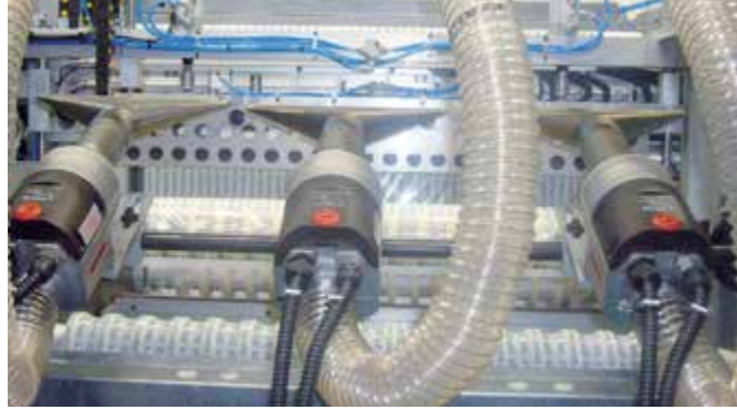
Tri LHS 60S grejači vazduha sa širokim šlic diznama na liniji za umotavanje.
