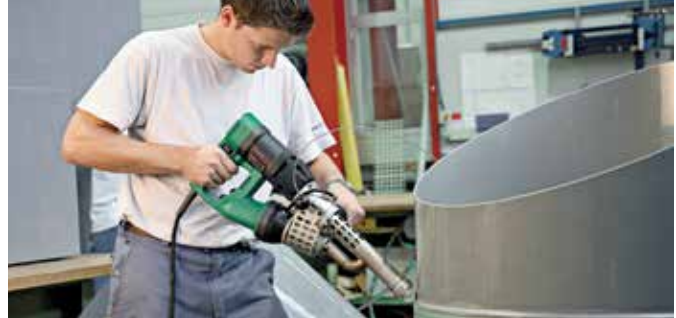
FUSION 3C prilikom pravljenja V-vara.
