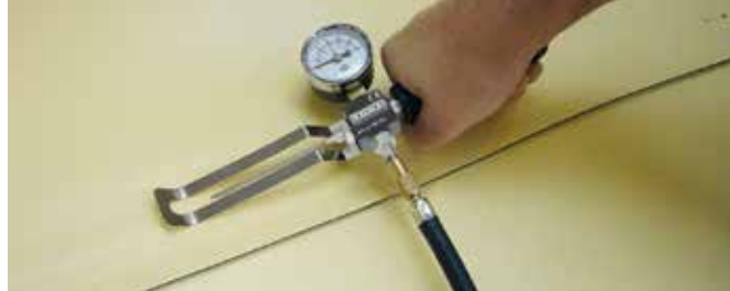
Ispitivanje propustljivosti šava sa test kanalom
