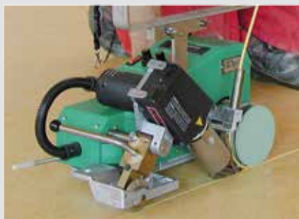
Korak 2: Ubacivanje elektrode za zavarivanje u žleb korišćenjem UNI-ROOF E varilice sa toplim vazduhom. (strana 94)
