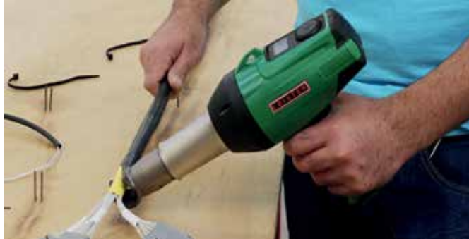
Pasovanje lema upotrebom HOT JET S sa reflektor diznom na navlačenje
