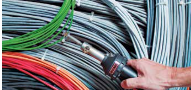
Pasovanje lema upotrebom HOT JET S sa reflektor diznom na navlačenje
