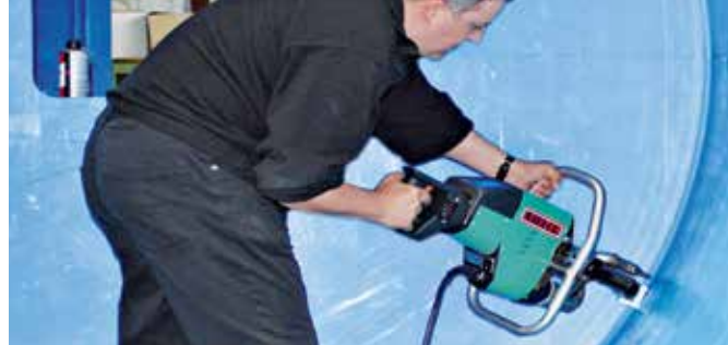
WELDPLAST S6 je lak za kontrolu zahvaljujući kružnoj dršci.
