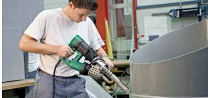
FUSION 3C prilikom pravljenja V-vara.
