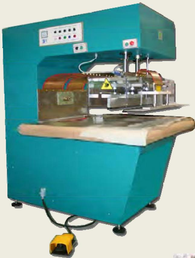
VF zavarivačka mašina za cerade (snage od 8 do 12 KW). Glavna prednost su joj mali gabariti, može se postaviti bilo gde. Pogodna je za mala i srednja zavarivanja, i isporučuje se u različitim bojama. Njen sto za zavarivanje je opremljen zaobljenim drvetom, kako bi se rukovaocu olakšao rad sa materijalom.
